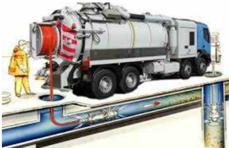
Зураг 3.8. Бохирын хоолойг өндөр даралттай усаар угаах зориулалтын машин
