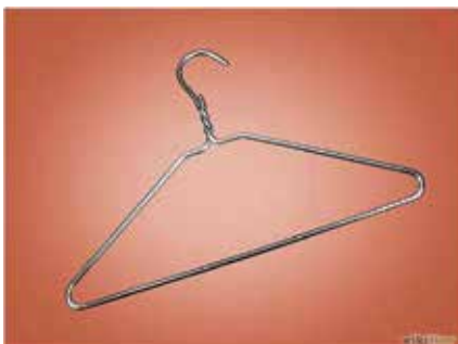
Зураг 2.19. Хэрэв бумбадалт үр дүнгүй болж юүлэх хэсгийн бөглөрлийг гаргах боломжгүй нөхцөлд төмөр утсан өлгүүрээр саадыг зайлуулах боломжтой.
