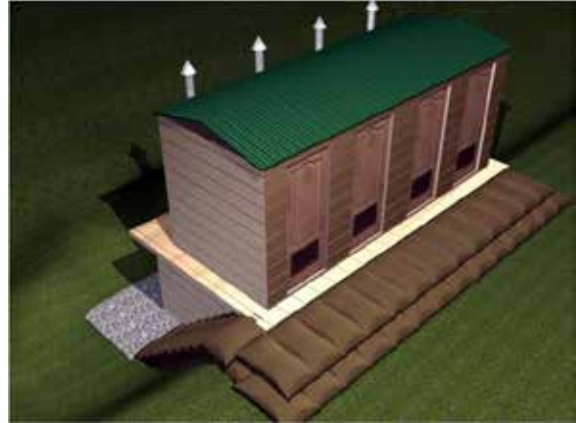
Зураг 2.109. Сумын эмнэлэг, сургууль, цэцэрлэгт барих боломжтой олон кабинтай хуурай жорлон
