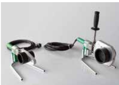
Зураг 2.67. Гагнуурын төхөөрөмжид хайлуулах хошууг суурилуулах.
